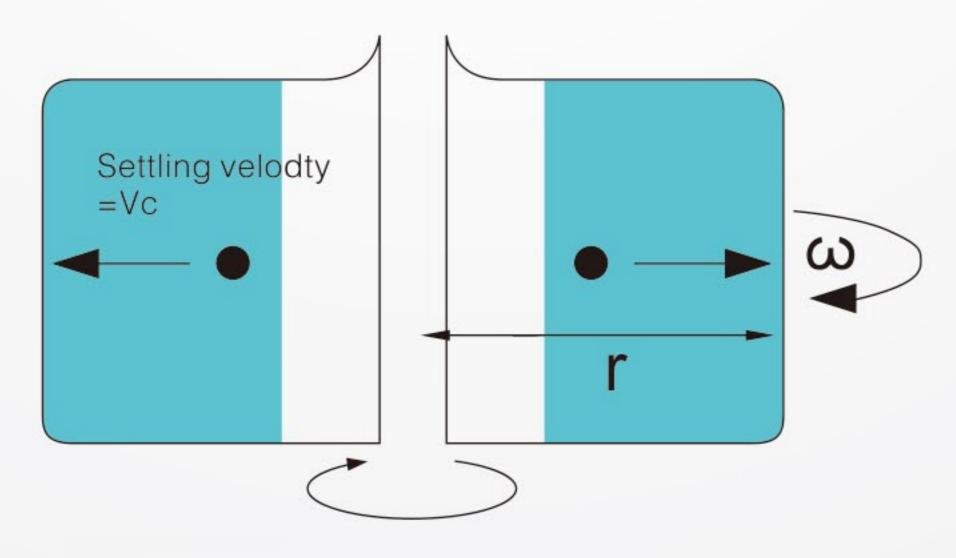
**Centrifugal separation Driving force** Γω<sup>2</sup>
